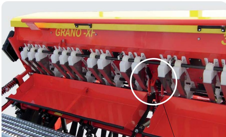
Dispositivo di esclusione mezza macchina.
